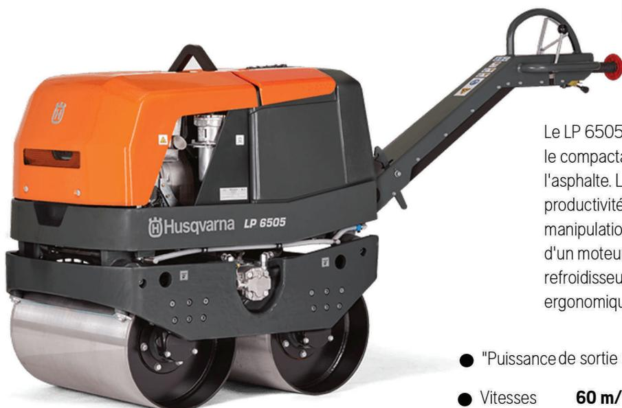
Le LP 6505 est un rouleau duplex entièrement hydraulique conçu pour le compactage de couches fines sur des sols pulvérulents et sur l'asphalte. La force centrifuge élevée et la vitesse augmentent la productivité, tandis que le design élégant et compact facilite la manipulation près des murs et dans les espaces confinés. Il est équipé d'un moteur diesel Hatz 1D42S à démarrage électrique et d'un refroidisseur d'huile hydraulique intégré, et dispose d'un design ergonomique facile d'entretien.
